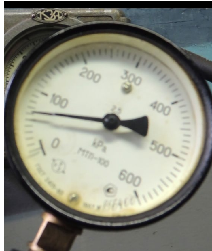
Показання манометру діагностичного устаткування у процесі вимірювання тиску повітря у порожнині «в» при пошуку несправності у роботі підігрівача системи АФП
