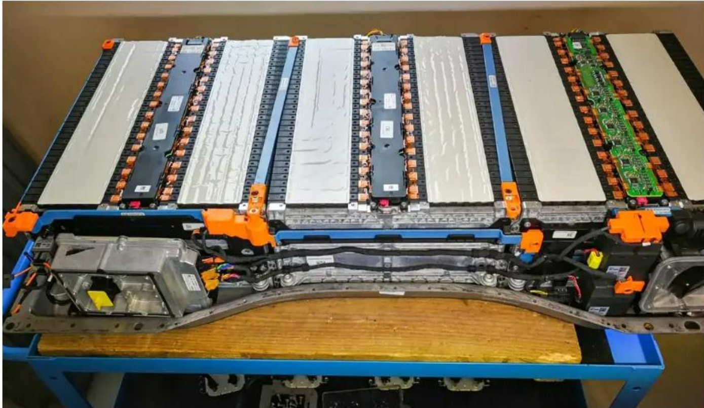
Рисунок 4 – Відкрита високовольтна батарея з демонтованими охолоджувальними пластинами.
