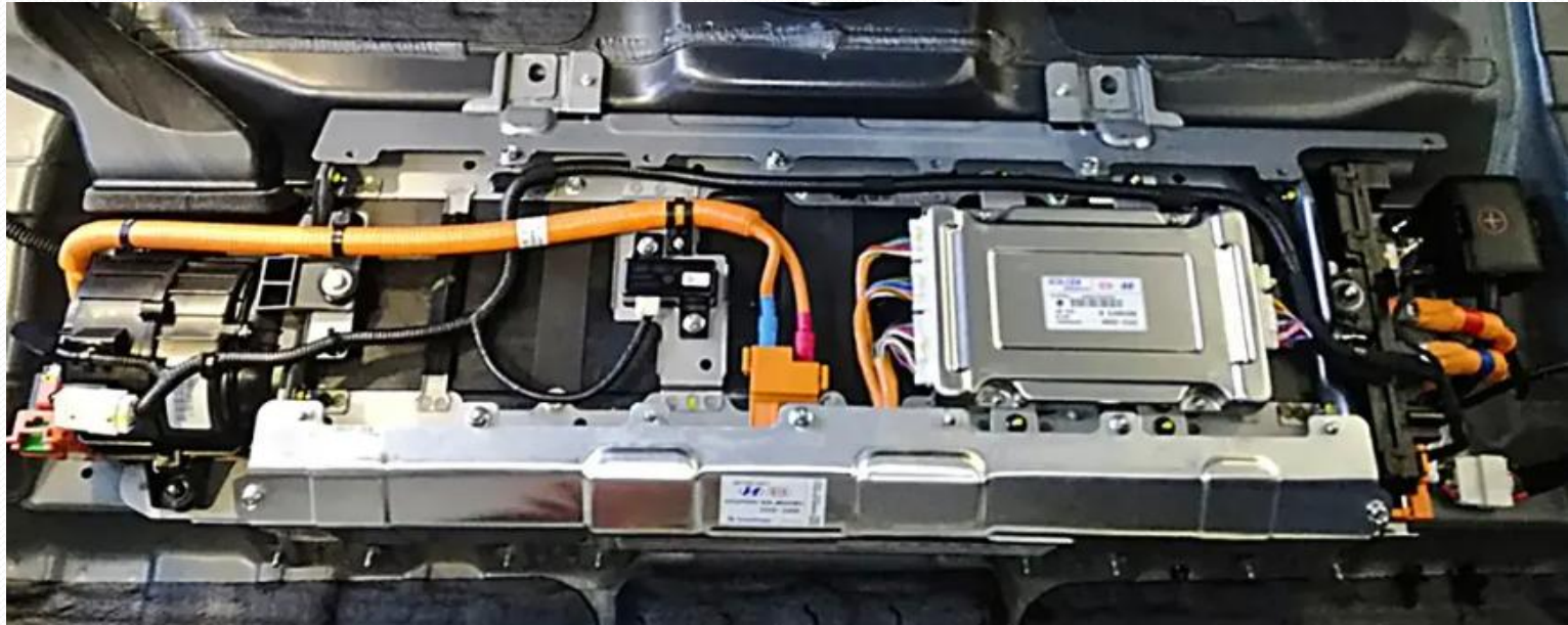
Рисунок 7- Високовольтній батареї використовується літій-полімерна технологія, де достатньо повітряного охолодження (з лівого боку видно корпус двигуна вентилятора, який працює з напругою 12 В)
